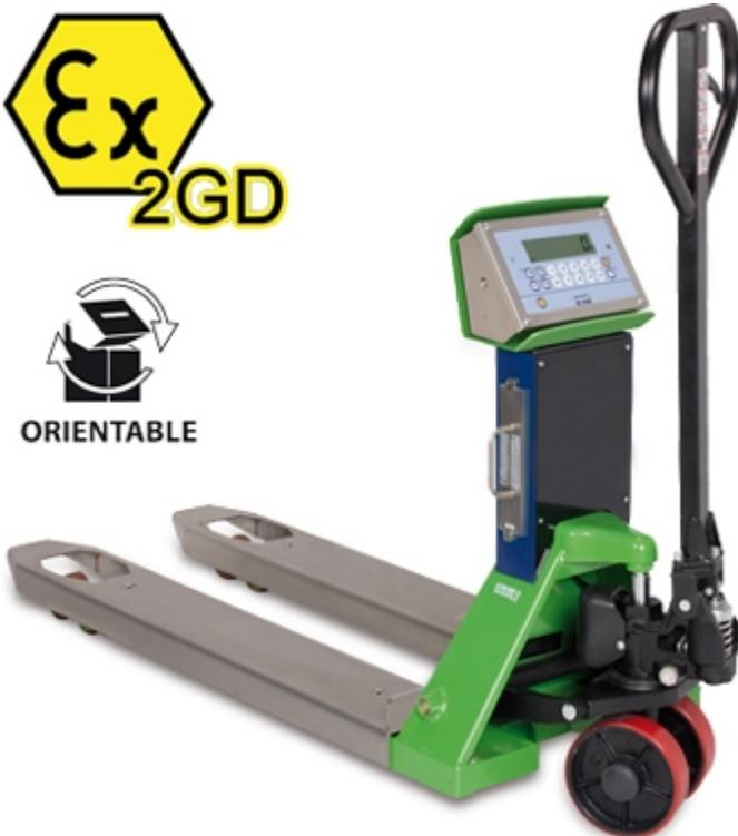
Transpallet con pesatura elettronica integrata per aree pericolose, classificate a rischio di esplosione (ZONE 1 e 21 & 2 e 22) con modo di protezione secondo Ex II 2G IIB T4 Gb X e Ex II 2D IIIC T197°C Db X.
